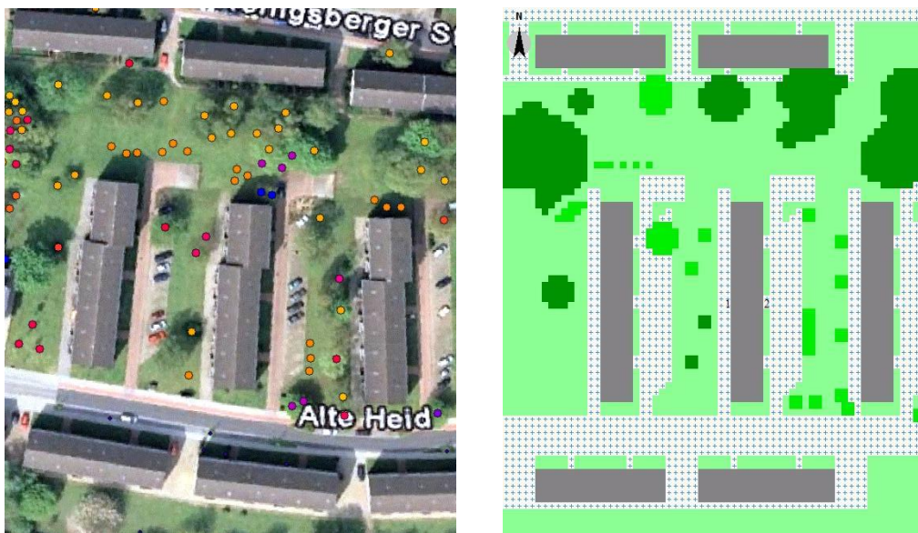
Abb. 9: Vergleich des Untersuchungsgebietes mit dem im Simulationsprogramm ENVI-met erstellten Computermodell zur Durchführung einer Parameterstudie über mikroklimatische Einflussfaktoren in urbanen Gebieten (ZIARNA 2012)
